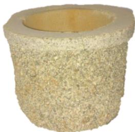
Fig. 1. Ceramic ATD10C-PŁ probe
