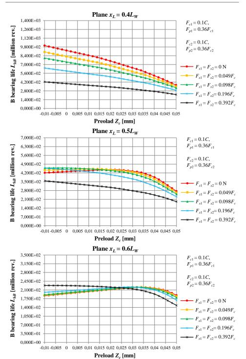
Fig. 7. Fatigue life of bearing B
