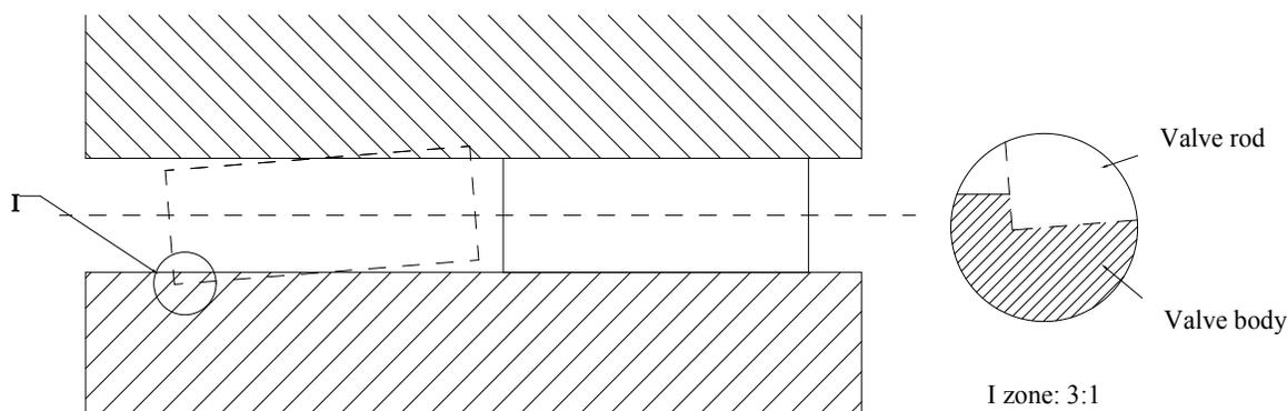
Fig. 9. Valve body and rod actual position
