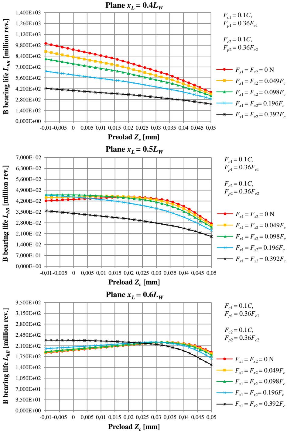
Fig. 7. Fatigue life of bearing B
