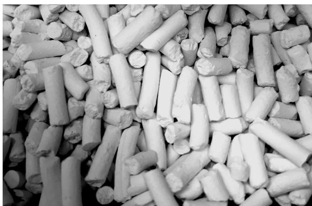
Fig. 1. Molecular sieves 13X
