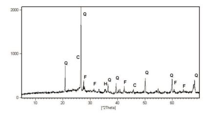
Fig. 1. X-ray pattern of fly ash used  $(Q - \beta$ -quartz, H – hematite, C – carbon, F – iron sulphate). Rys. 1. Wyniki dyfraktometrii rentgenowskiej popiołu lotnego wykorzystanego w badaniach  $(Q - \beta$ -kwarc, H – hematyt, C – węgiel, F – siarczyn żelaza)
