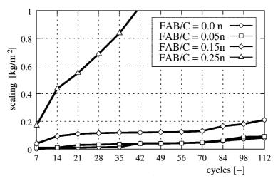
Fig. 5. Results of the scaling resistance tested according to CEN/TS 12390-9:2007, [5] Rys. 5. Wyniki badania odporności na powierzchniowe łuszczenie wg CEN/TS 12390-9:2007, [5]
