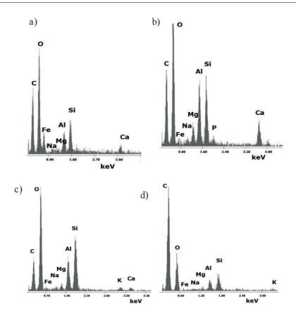
Fig. 3. EDS analysis results in points marked in Fig. 2: a) point 1; b) point 2; c) point 3; d) point 4. Rys. 3. Wyniki analizy EDS w punktach wskazanych na Rys. 2: a) punkt 1; b) punkt 2; c) punkt 3; d) punkt 4
