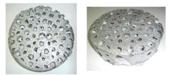
Fig. 9. Casting (AlSi10MgMn) - type II
